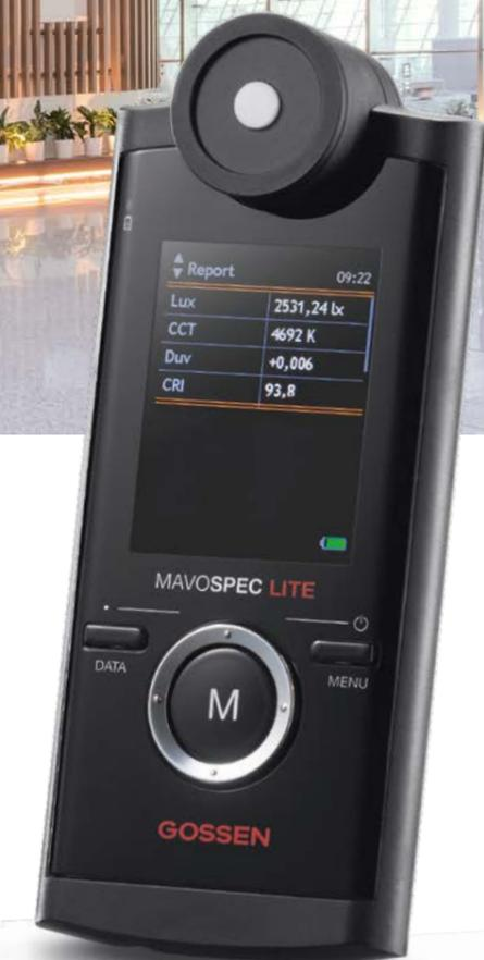
KONTINUIERLICHE AUFZEICHNUNG – Das mitgelieferte EXCEL Template „Datenlogger Vx.xx.xlsm“ stellt zudem eine Datenlogger Funktion bereit. Es können entweder einzelne Messungen oder kontinuierliche Messungen mit einstellbarem Messintervall durchgeführt und im Tabellenblatt Data abgelegt werden. In der grafischen Anzeige erscheint die jeweilige Spektralkurve und unterhalb werden die Positionen im CIE 1931 und CIE 1976 Farb-raum angezeigt.
